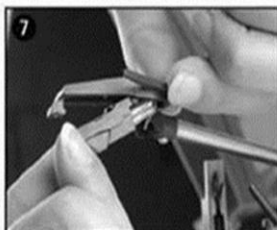
3 Lösen Sie die Patrone leicht vom Sockel.
