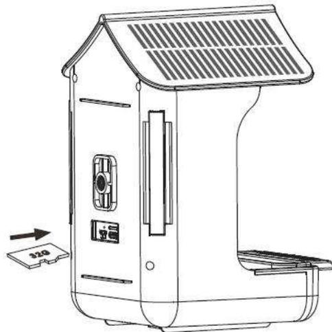
**Nota:** soltanto con la scheda SD inserita il dispositivo è in grado di funzionare correttamente. Se la scheda SD non viene inserita non è possibile utilizzare le rispettive funzioni.
