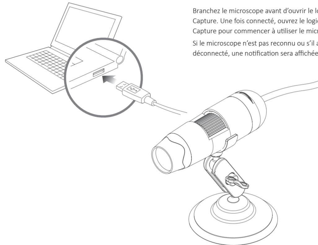
Branchez le microscope avant d'ouvrir le logiciel Micro Capture. Une fois connecté, ouvrez le logiciel Micro Capture pour commencer à utiliser le microscope.
