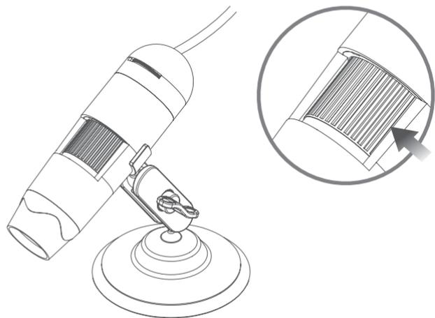
Pour focaliser le microscope, faites tourner la roue de mise au point à l'avant du microscope. dans le sens des aiguilles d'une montre pour effectuer un zoom avant ou dans le sens inverse pour effectuer un zoom arrière. En utilisant le logiciel, vous pourrez voir à l'écran si le DX-1 est mis au point.
