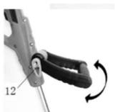
Poluzuj pokrętło blokady regulacji uchwytu pomocniczego, aż będzie można go przesuwać do przodu lub do tyłu bez większego oporu. Ustaw żądaną pozycję i ponownie dokręć pokrętło blokujące.
