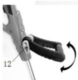
Desserrez le bouton de verrouillage de la poignée d'assistance jusqu'à ce qu'elle puisse être déplacée vers l'avant ou vers l'arrière sans trop de résistance. Ajustez-la à la position souhaitée et resserrez le bouton de verrouillage.
