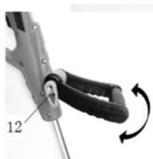
Afloje el pomo de bloqueo de ajuste de la empuñadura de asistencia hasta que pueda moverse hacia delante o hacia atrás sin mucha resistencia. Ajústelo a la posición deseada y vuelva a apretar el pomo de bloqueo.
