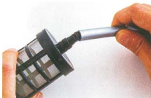
3. Sluit de slang koppeling aan op de hogedrukspuit
