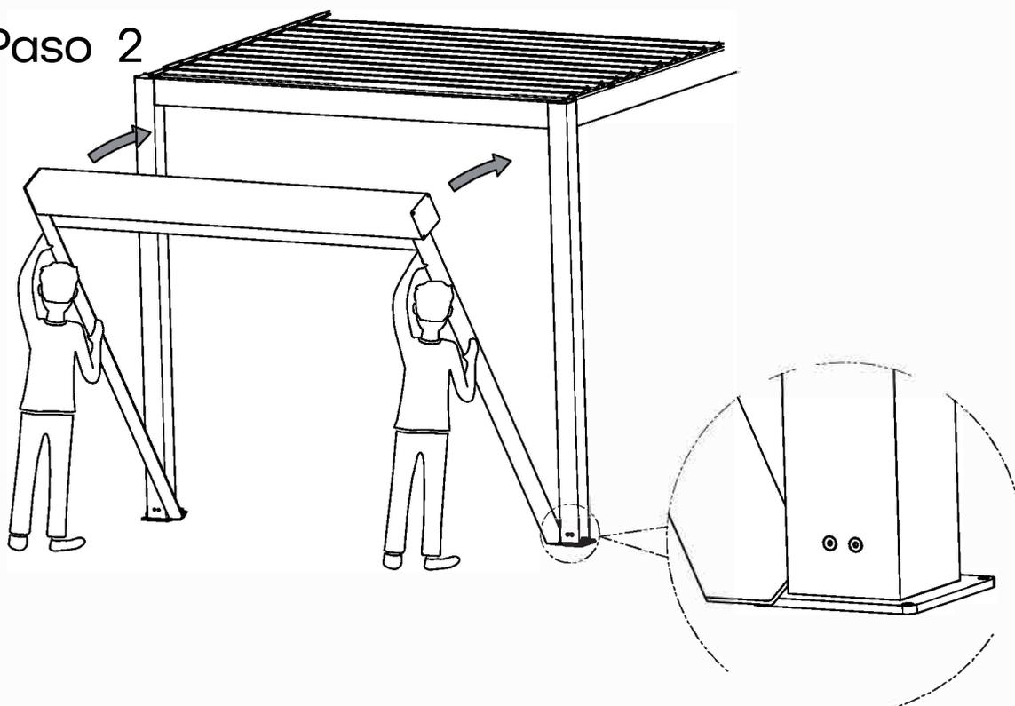
Coloque el módulo principal en dos columnas de la pérgola para su instalación y ajuste la posición adecuadamente.
