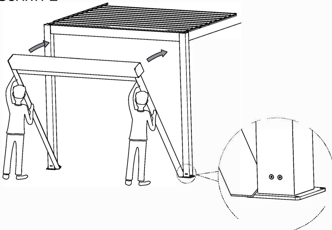
Setzen Sie das Hauptmodul in die beiden Pfeiler der Pergola. Richten Sie die Position entsprechend aus.
