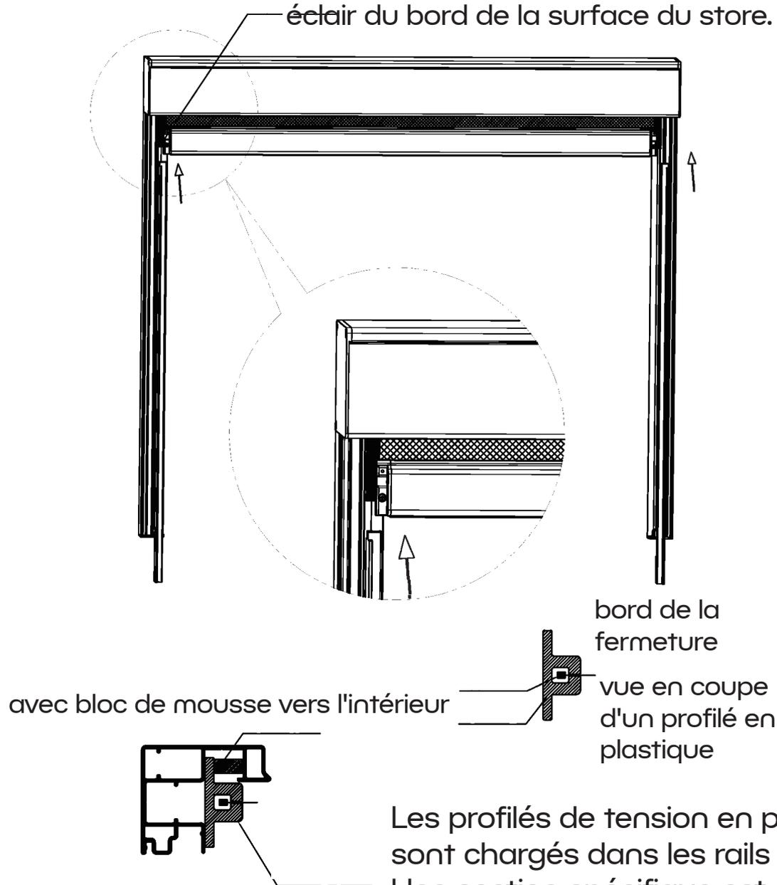
Les profilés de tension en plastique sont chargés dans les rails fixes. Une section spécifique est représentée sur la figure.
