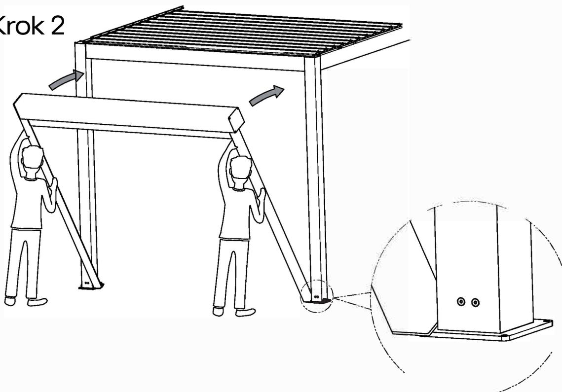
Umieść moduł główny w dwóch kolumnach pergoli w celu montażu i odpowiednio dostosuj położenie.
