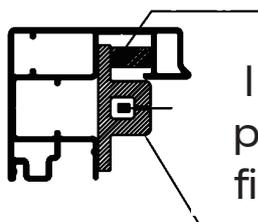
I profili di tensionamento in plastica vanno posti nelle guide fisse.
