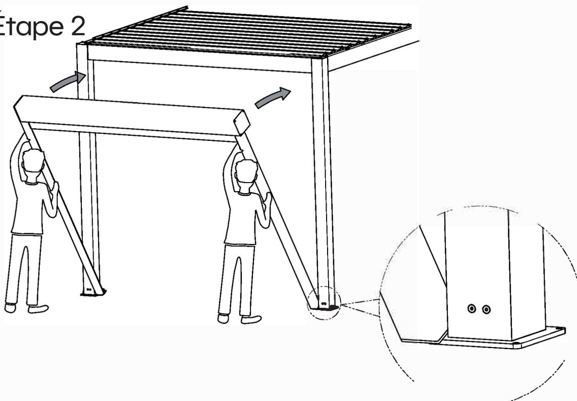
Placez le module principal dans les deux colonnes de la pergola pour l'installation et ajustez sa position en conséquence.
