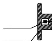
Querschnittsansicht des Klemmprofils
