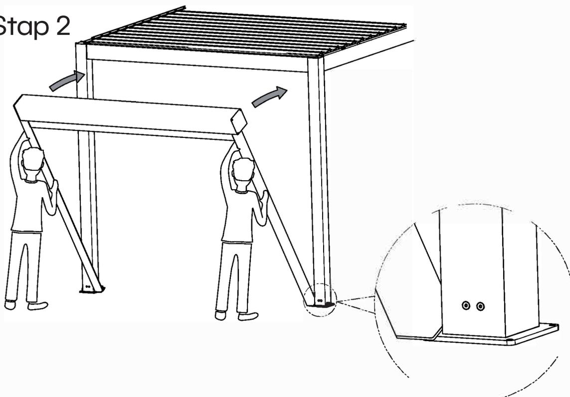
Plaats de hoofdmodule in de twee palen van de pergola om de module te installeren en pas de positie van de hoofdmodule vervolgens op correcte wijze aan.
