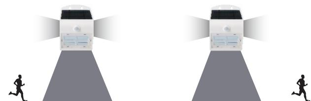
**Modus A:** Beleuchtung schaltet sich bei Eintritt der Dämmerung automatisch mit einer Helligkeit von 20% ein (<30lux) und schaltet sich nach 5 Stunden wieder aus.
