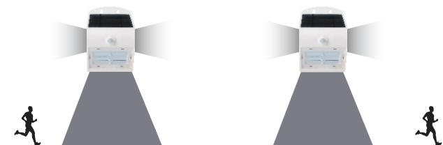
**Modo A:** se enciende automáticamente al anochecer (< 30 lux) y permanece con el brillo al 20 % durante hasta 5 horas, tras lo cual, se apaga.
