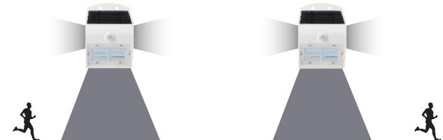
**Mode A :** s'allume automatiquement au crépuscule (<30 lux) et reste allumé à 20 % jusqu'à 5 heures, après quoi il s'éteint.
