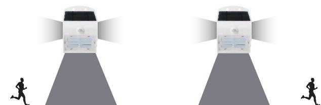
**Modus A:** De lamp gaat automatisch aan wanneer het begint te schemeren (<30 lux) en blijft vijf uur lang op 20% sterkte branden, waarna hij automatisch weer uitgaat.
