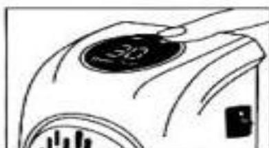
3. Wählen Sie Ihre gewünschte Temperatur. Verwenden Sie die "+"-Taste, um die Temperatur zu erhöhen oder die "-" -Taste, um die Temperatur auf 15°C bis 32°C zu senken.
