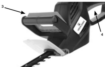
Mise en marche: en tenant la poignée, relevez l'interrupteur Marche / Arrêt (4) situé sous la poignée et, de l'autre main, poussez simultanément sur l'interrupteur de poignée avant (3).
