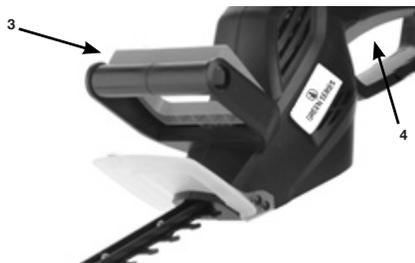
Inschakelen: hou de hendel vast, trek de aan / uit-schakelaar (4) aan de onderkant van de hendel omhoog en duw tegelijkertijd met uw andere hand op de schakelaar op het voorste handvat (3).
