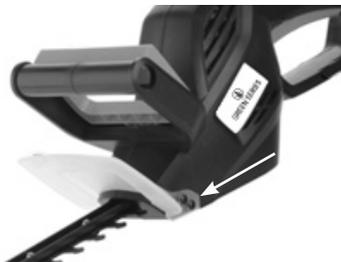
Schieben Sie den Griffschutz (2) über die Klingen und befestigen Sie ihn mit Schrauben an beiden Seiten des Gehäuses.
